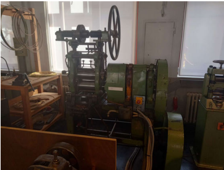
Hand- und Motorgetriebene Walzen. Blech- und Drahtwalzen. Größte Blechwalze mit Motor: Ø12 x 20 cm
